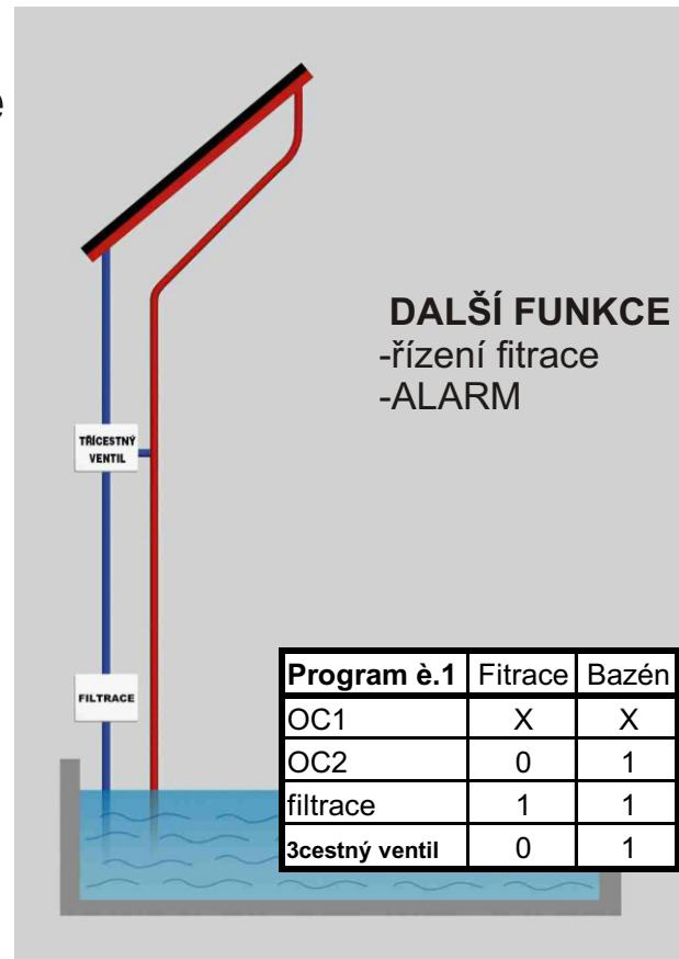
Program č.1 se používá pokud solární panely slouží k ohřevu bazénu. Jestliže je k oběhu vody využito čerpadlo od filtrace, může tato řídící jednotka ovládat i filtraci bazénu. V případě použití jiného motoru než od filtrace, využijeme výstup pro OC2. Výstupy jsou spínány podle pravdivostní tabulky č.1
